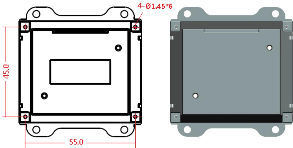
三、侧视安装固定槽，有 4 个 2.0 自攻螺丝槽，槽的高度是 5.5mm,深度是 6.0mm
